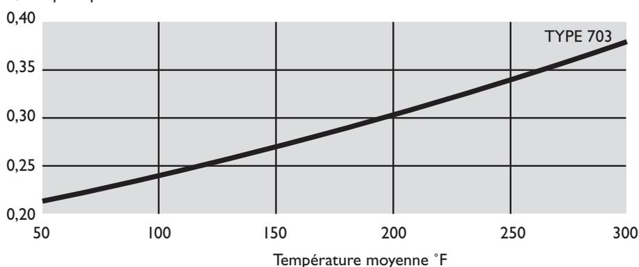
La courbe de conductivité thermique apparente a été établie en conformité avec la procédure ASTM C1045 selon les données obtenues par la méthode d'essai ASTM C177. Les valeurs sont nominales et sujettes à des essais normaux et aux tolérances de fabrication.
