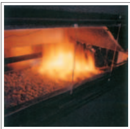
Certains échantillons de cellulose ont échoué l'essai de résistance au feu ASTM E 970 six mois seulement après leur mise en place.
