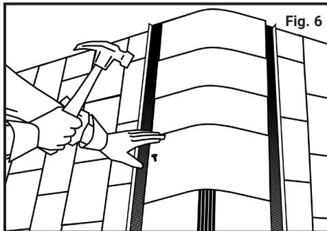
cual usted instale el siguiente segmento de ventilación de cumbre. Para instalaciones en climas fríos, deje un espacio no mayor a  $\frac{1}{8}$  pulgadas para dar lugar a la expansión. Si hubiera huecos mayores a  $\frac{1}{8}$  pulgadas, podría haber filtraciones de lluvia y nieve en el ático.
