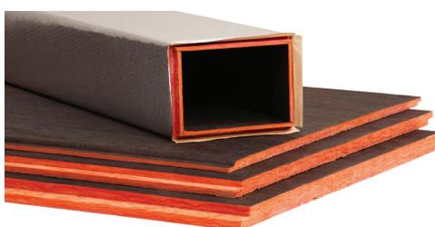
La placa para conductos QuietR® de Owens Corning® es una placa rígida de fibra de vidrio unida con resina, con un revestimiento duro de papel aluminio reforzado (FRK), resistente a daños y retardador del fuego, y con una superficie aerodinámica durable.
