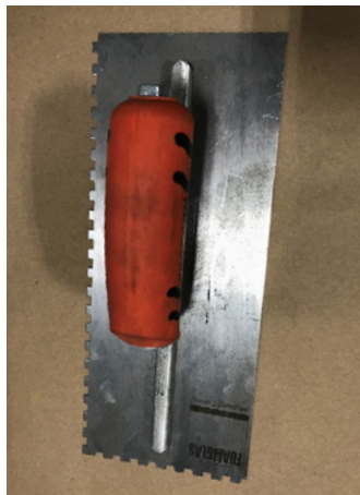
Paso 1: Extender con una llana de borde plano
