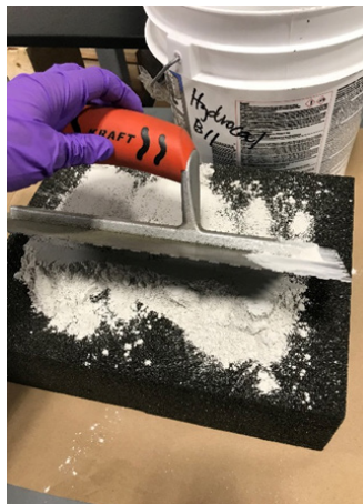
Paso 3: Españir el polvo con el borde plano de la llana.
