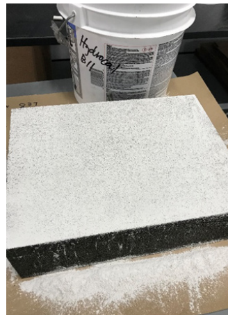
Paso 4: Dejar que el exceso de polvo caiga del borde del bloque. (Reservar el exceso para usar en la otra cara)
