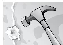
**1. PRÉPARATION DES MURS** Assurez-vous que le mur de béton soit aussi plat que possible; utilisez un marteau pour niveler la surface.
