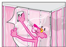
**3. Installation d'un pare-vapeur/pare-air.** Installez un film de polyéthylène scellé sur toute la surface du mur pour créer un pare-vapeur/pare-air.
