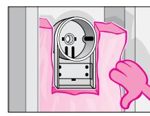
**Isolation de la tuyauterie dans les murs extérieurs.** Pour isoler autour de la tuyauterie d'alimentation d'eau installée dans les murs extérieurs, l'isolant doit toujours être installé derrière les tuyaux pour s'assurer que les tuyaux restent du côté chaud de l'assemblage mural.
