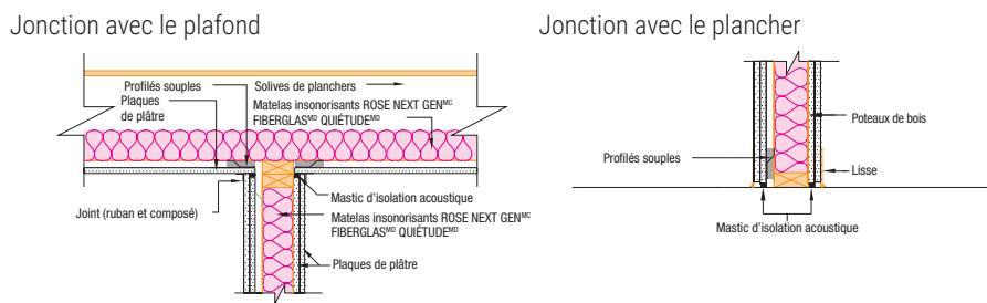
**Mur à ossature simple en bois (deux épaisseurs de plaques de plâtre sur un côté et une épaisseur de l'autre côté)**
