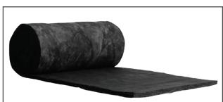
**Matelas acoustique noir SelectSound<sup>MD</sup>** : Il est fait de fibres de verre inorganiques et d'un liant à base de résine thermodurcissable et est formé en matelas flexibles. Il est stable du point de vue dimensionnel et il ne rétrécit pas et ne gauchit pas. Il convient parfaitement dans les cas où l'on désire supprimer les reflets lumineux tout en assurant une performance acoustique exceptionnelle.
